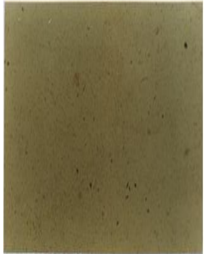
صورة (3) بالمجهر الضوئي لسطح البولي ستايرين قبل التشعيع المضاف اليه كلوريد الحديدك بتركيز 0.05 ويظهر شكل حبيبات الملح
