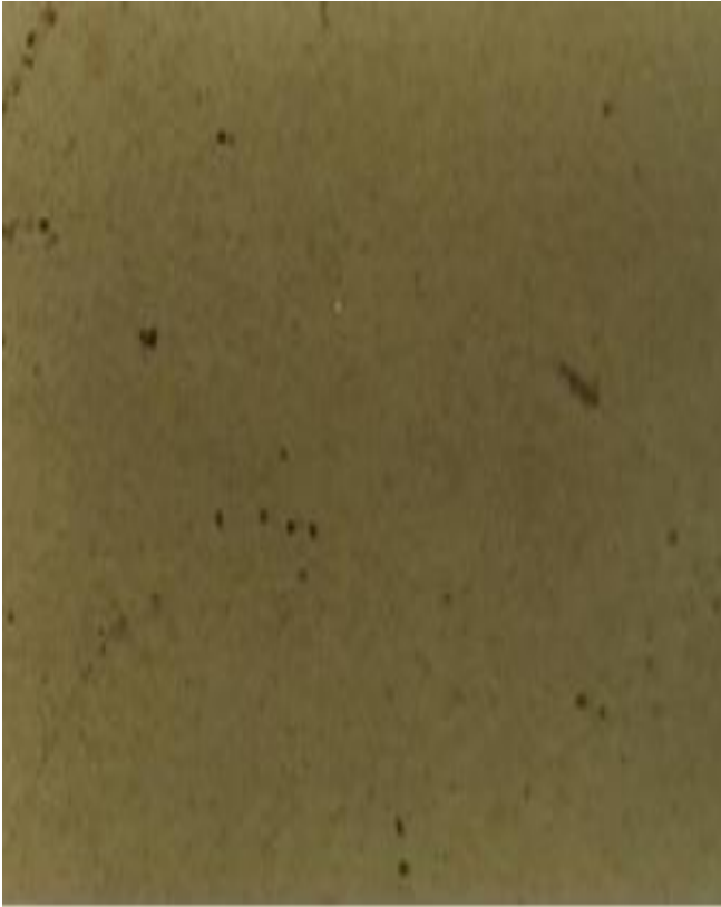
صورة (5) بالمجهر الضوئي لسطح البولي ستايرين قبل التشعيع المضاف اليه كلوريد الحديدك بتركيز 0.2 ويظهر شكل حبيبات الملح
