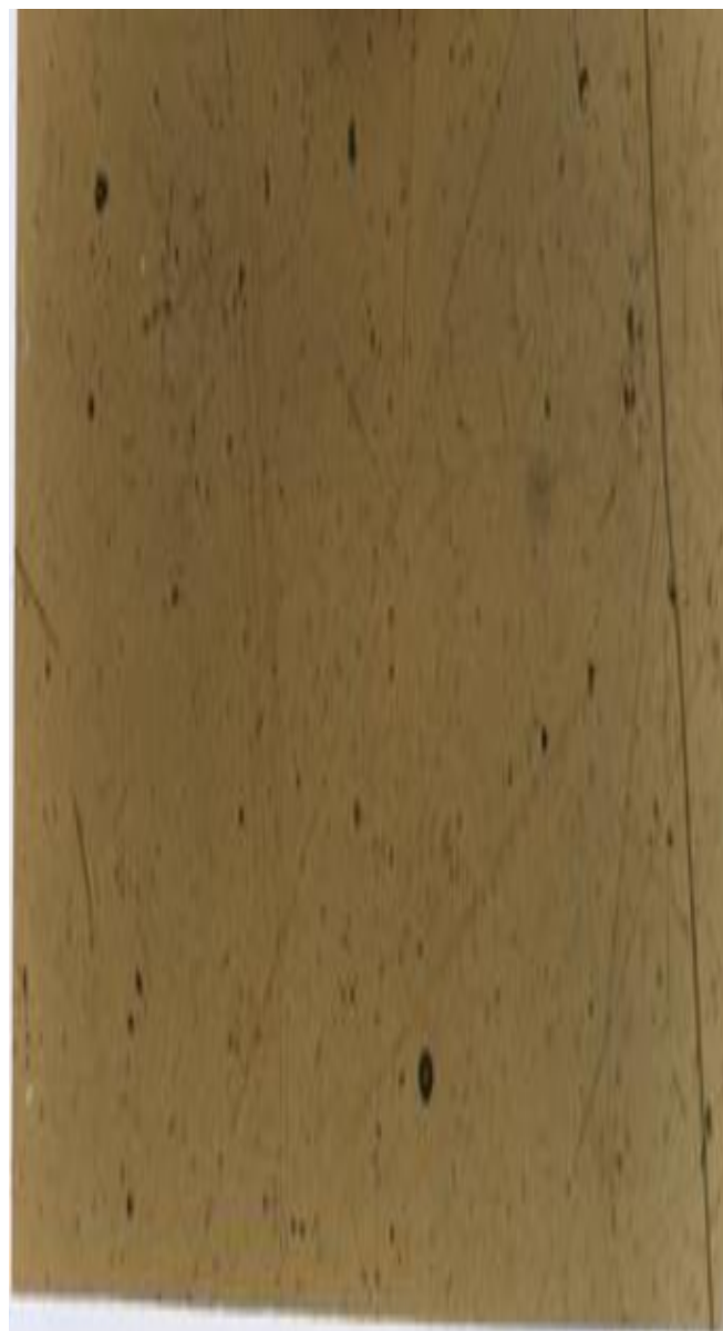
صورة ( 7 ) بالمجهر الضوئي لسطح البولي ستايرين قبل التشعيع المضاف اليه كلوريد الحديدك بتركيز 0.4 ويظهر شكل حبيبات الملح
