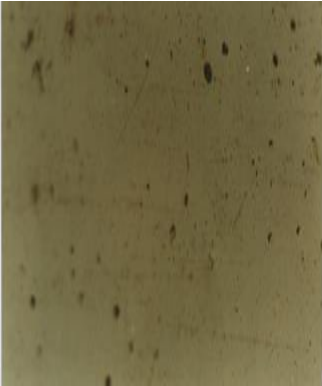
صورة (1) بالمجهر الضوئي لسطح البولي ستايرين قبل التشعيع المضاف اليه كلوريد الحديدك بتركيز 0.025 ويظهر شكل حبيبات الملح
