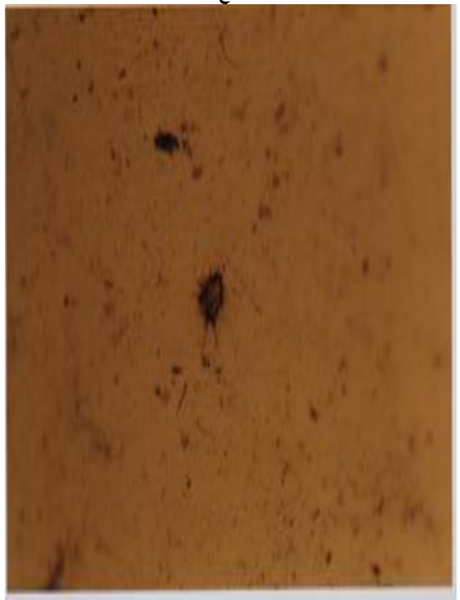
صورة (4) بالمجهر الضوئي لسطح البولي ستايرين بعد التشعيع المضاف اليه كلوريد الحديدك بتركيز 0.05 ويظهر ندبات بشكل اقل من التركيز السابق
