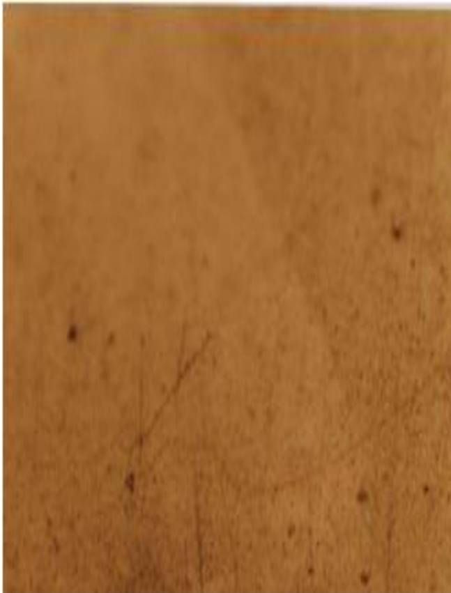
صورة (6) بالمجهر الضوئي لسطح البولي ستايرين بعد التشعيع المضاف اليه كلوريد الحديدك بتركيز 0.2 ويظهر اختفاء الندبات وتأثر السطح بشكل طفيف
