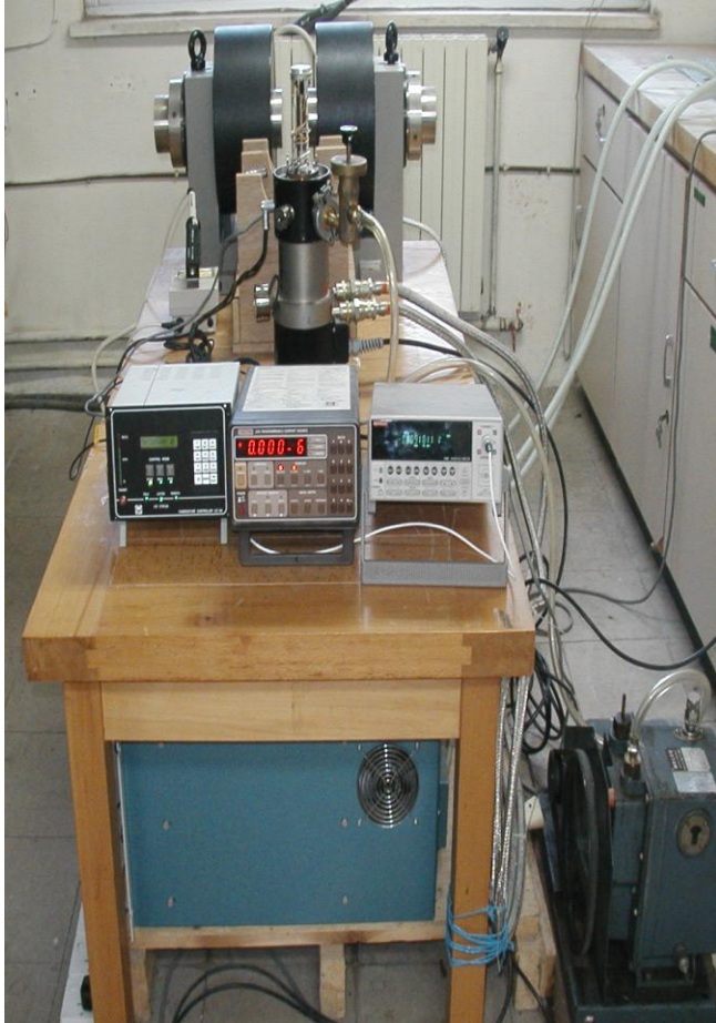
الشكل (٥) منظومة لقياس فرق الجهد والتيار للمركب في الدرجات الحرارية المنخفضة
